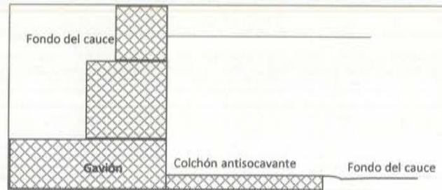
Figura 34. Muro de gaviones
