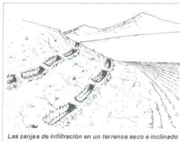
Figura 37. Zanjas de infiltración
