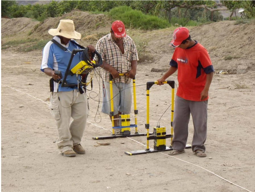
Foto N° 1 – Línea de Georadar LR-4 colindante a la zona agrícola se observa las dos antenas de 100 Mhz con espaciamentos de 1 m de las antenas y medidas cada 0.25 m.
