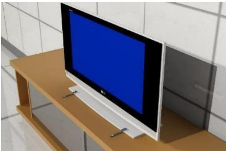
**Figura 9.2.3.6.** Formas de asegurar equipos electrónicos, mediante seguros de correas
