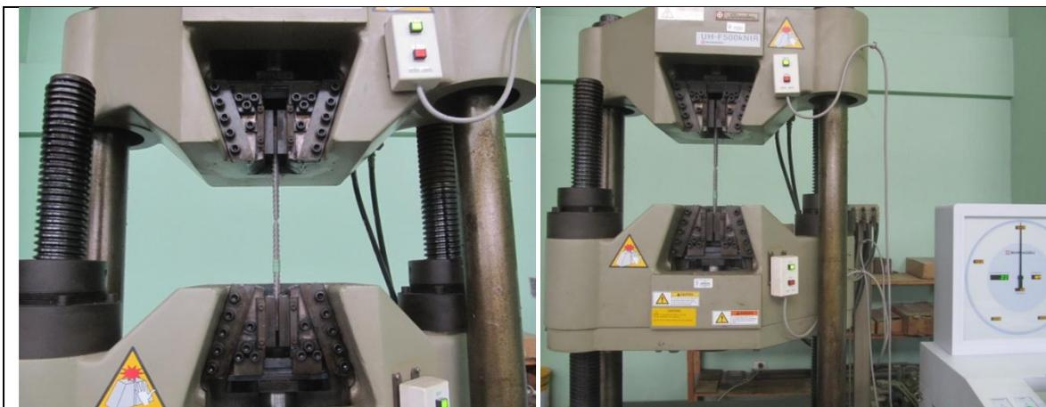
Foto 4.4.21 Ensayo de tracción de muestras de acero
