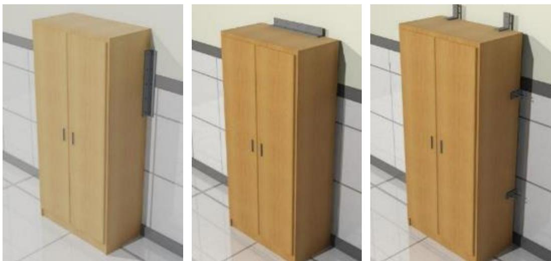
**Figura 9.2.3.4.** Muebles y armarios deben estar fijados y asegurados afín de evitar caídas que afecten al personal de salud o que obstruyan salidas o corredores de evacuación.
