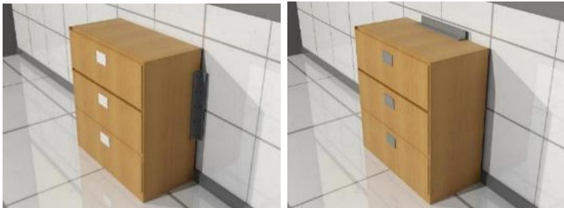
**Figura 9.2.3.3.** Archiveros deben estar asegurados y evitar caídas que obstruyan salidas o corredores de evacuación.
