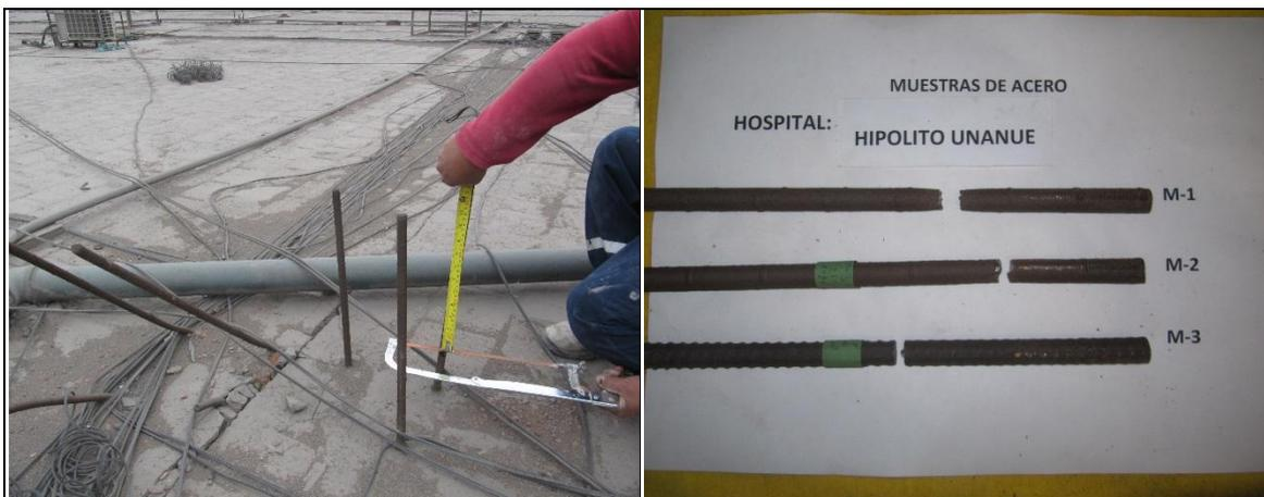
Foto 4.4.20 Corte de muestras en el hospital y muestras después del ensayo de tracción.
