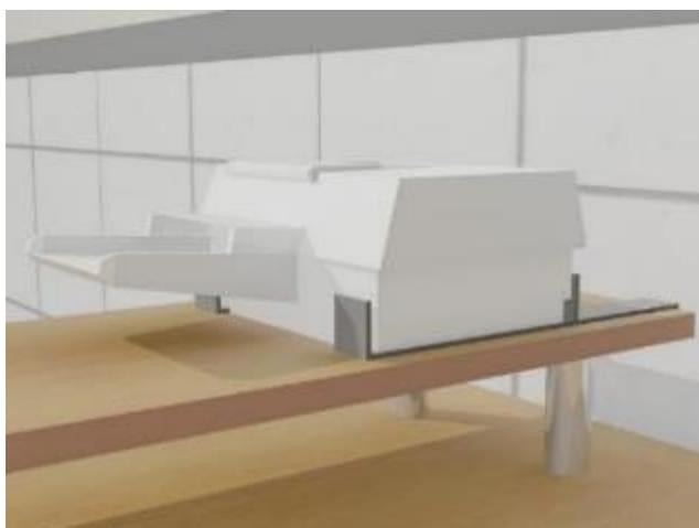
**Figura 9.2.3.2.** Equipos como impresoras deben estar sujetos a asegurados para evitar su desplazamiento ante movimientos sísmicos.
