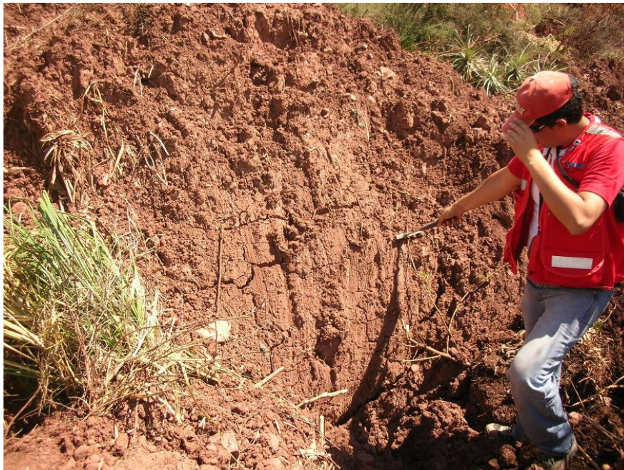
Foto 38. Bloques con presencia de estrías al límite entre el flujo F-3 con F-2
