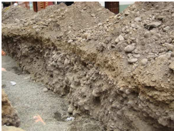
Foto Suelo de GW-GM son grava mal graduada, y una mezcla de grava, limo y arcilla, consistente, observado en una zanja en una calle a la altura de la cuadra 6 de la Avenida Morales Duárez.
