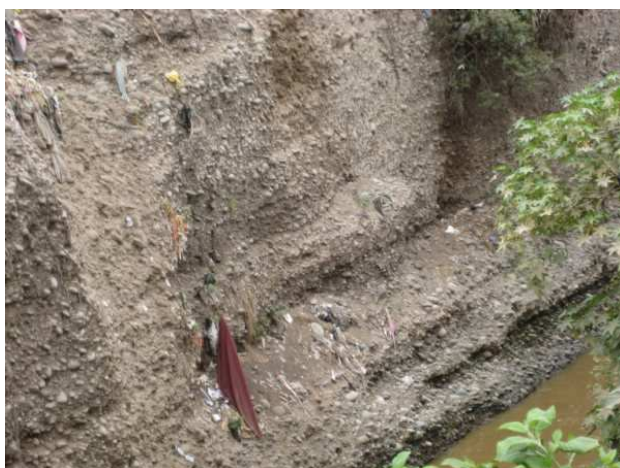
Foto: Un conjunto predominante de grava gruesa con limo y arcilla conforma el depósito aluvial.
