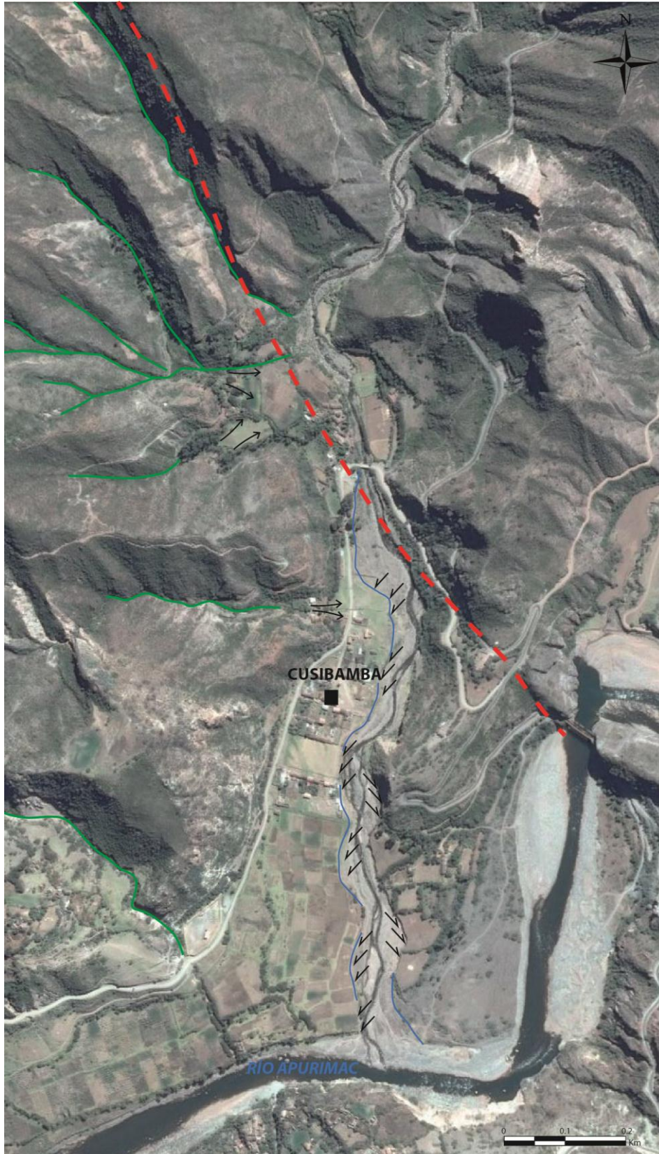
Figura 20: Inventario de movimientos en masa que se encuentran en el poblado de Cusibamba, donde se observa que el mayor peligro por su ubicación es la erosión fluvial (flechas negras y líneas azules) y los flujos de detritos.
