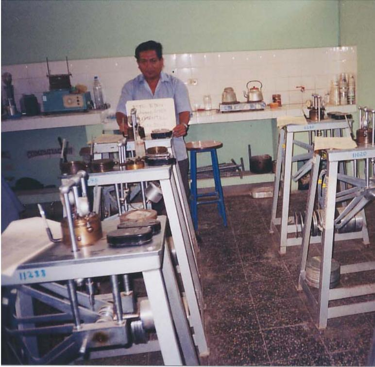
Foto Nro. 10. Variados equipos para el ensayo de consolidación
