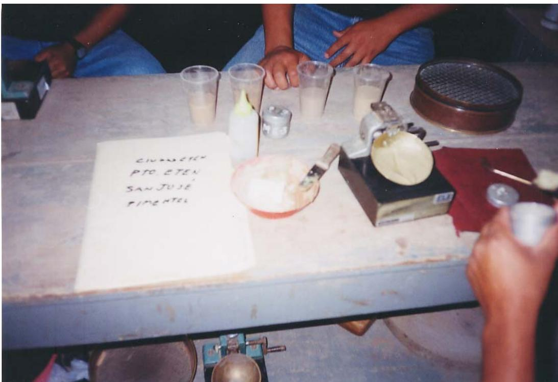
Foto Nro.2. Ensayo de límite líquido
