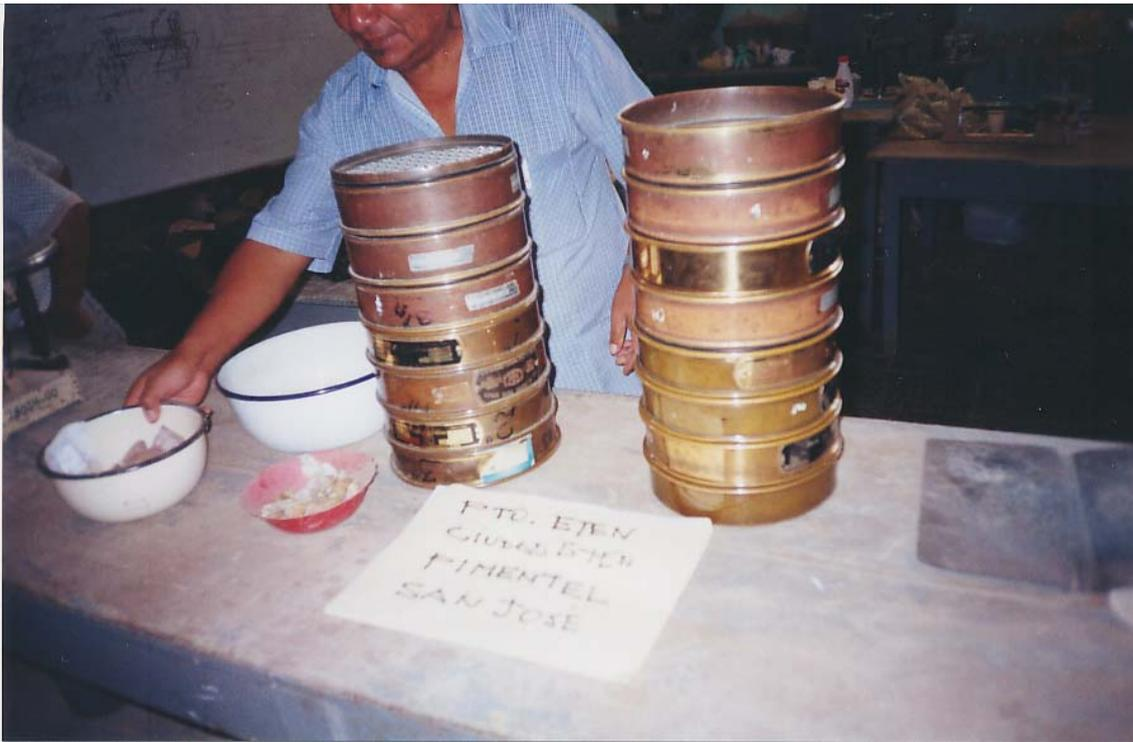
Foto Nro. 1. Ensayo de Análisis granulométrico
