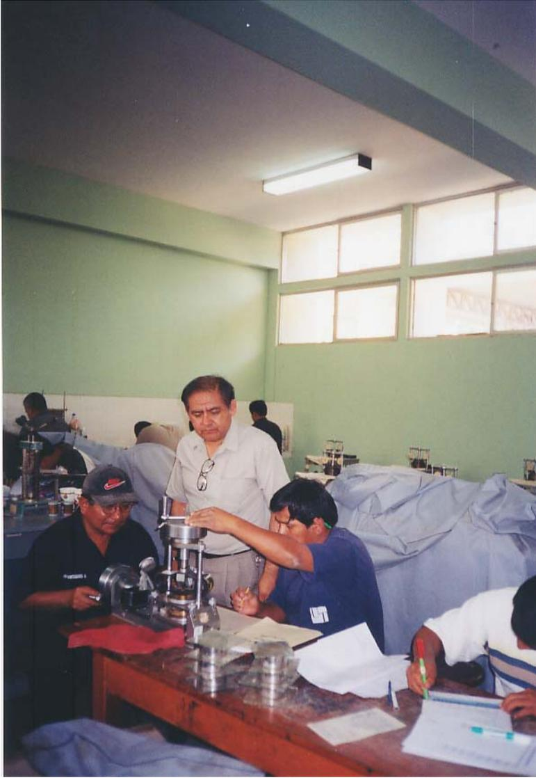
Foto Nro. 7 Supervisión del ensayo de corte directo.
