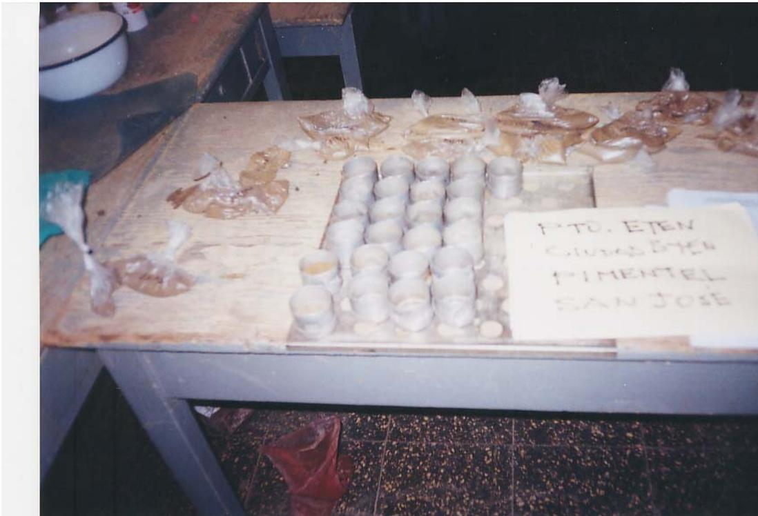
Foto Nro. 4. Ensayo de contenido de humedad
