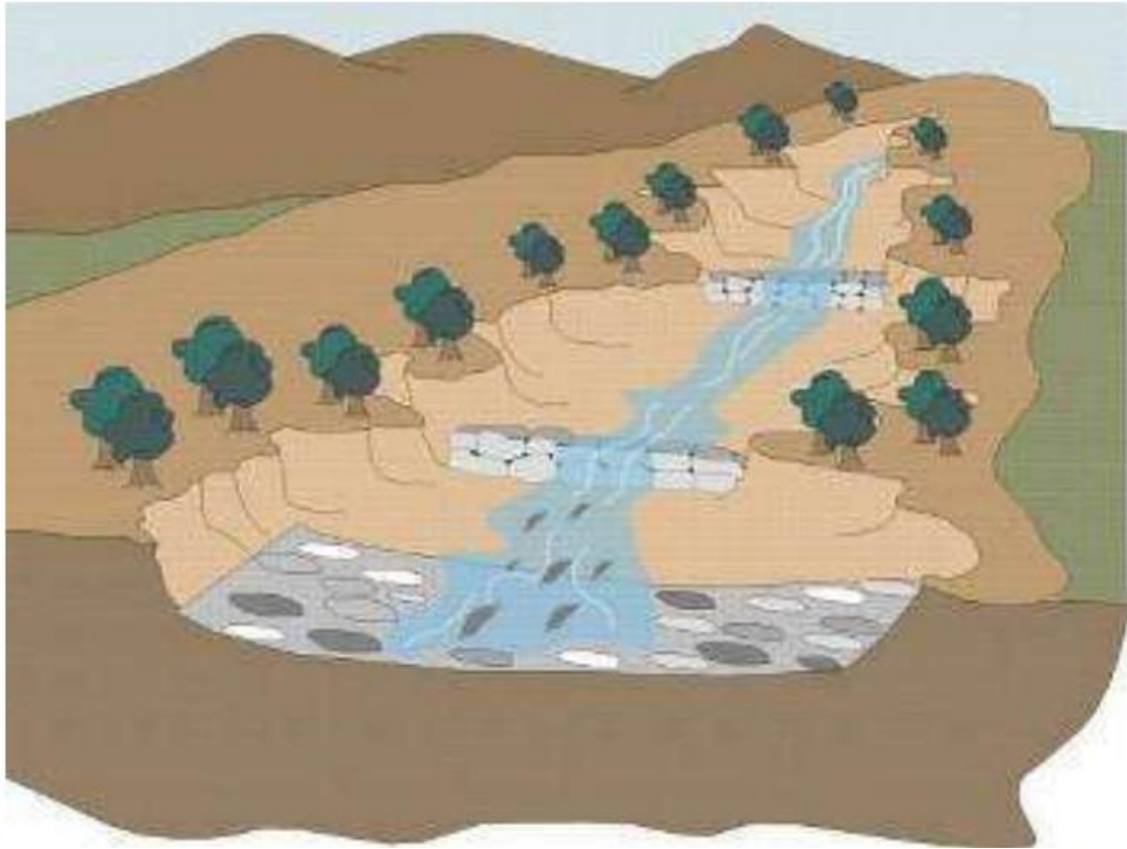
Figura 04: Presas de sedimentación escalonada para controlar la fuerza destructiva de los huaicos. Fuente: INGEMMET, 2003
