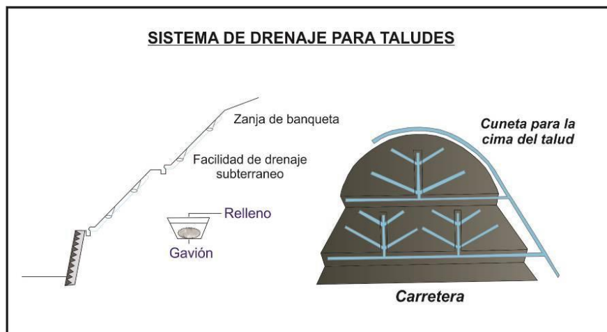
Figura 03: Sistema de drenaje tipo espina de pez
