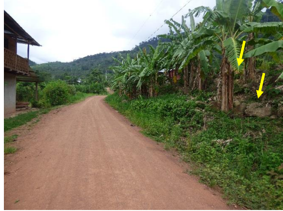
Fotos 3 y 4. Bloques de hasta 2 m de diámetro de formas subangulosas, producto del depósito de deslizamiento antiguo (fechas amarillas)
