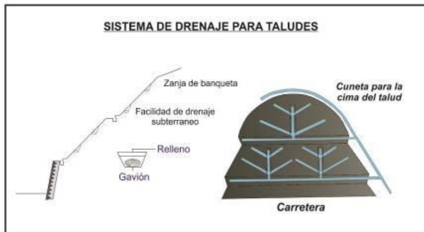
Figura 10. Sistema de drenaje tipo espina de pez.
