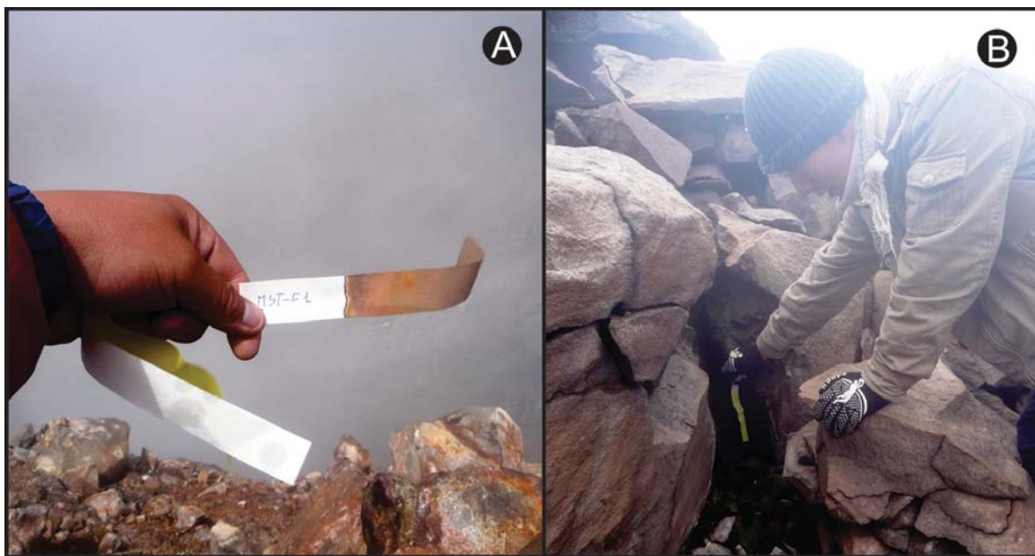
Figura 2.14 A) Ensayos cualitativos del gas ácido sulfhídrico ( H_2S ), realizados en las fumarolas en el cráter del Misti. A) En la estación MST-F1. B) En la estación MST-F3.
