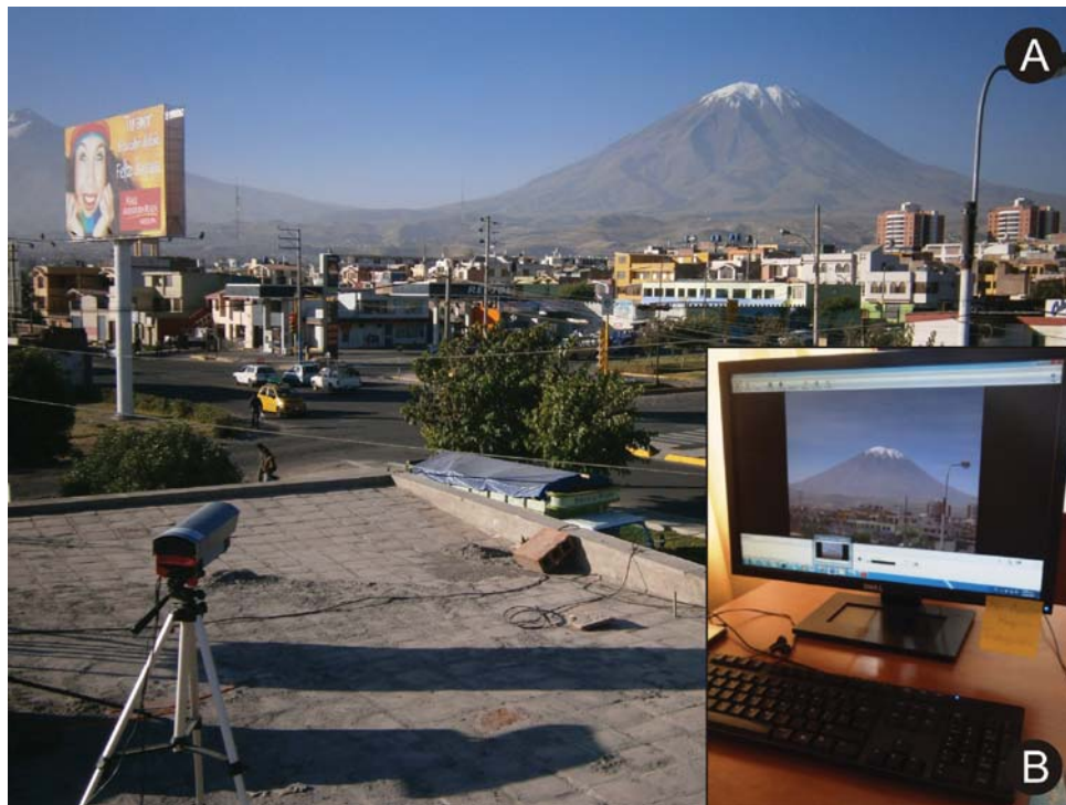
Figura 4.4 Estación MST-V1(A) Imagen de la cámara de video que monitoreo el volcán Misti. (B) Imágenes de los registros digitales de la estación de monitoreo visual MST-V1
