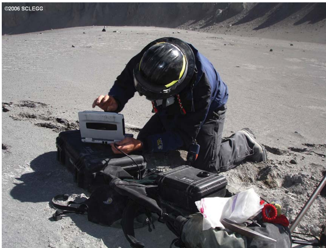
Figura 5.8 Calibración del equipo «FLYSPEC» para realizar las mediciones de SO 2 en la caldera del volcán Ubinas (tomado de Clegg, 2006).
