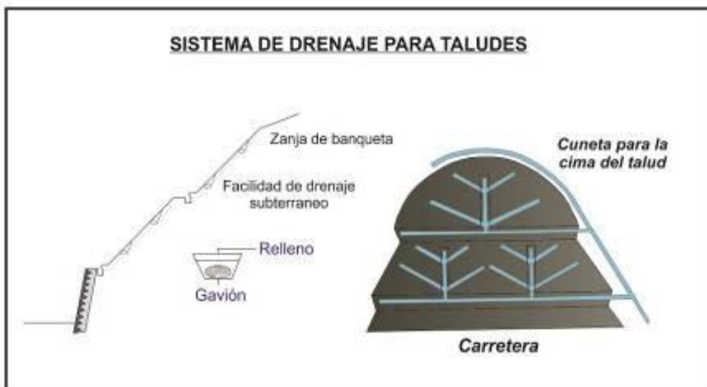
Figura 8. Sistema de drenaje tipo espina de pez.
