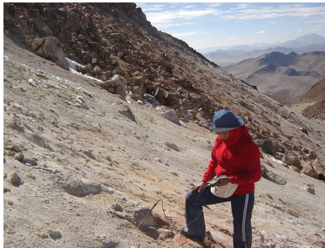
Fig. 5.15. Medición de temperatura de la fumarola del volcán Ticsani
