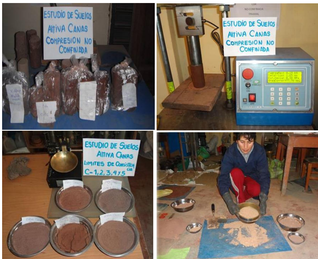
Figuras 2.5.- Ensayo de compresión no confinada y límites de consistencia Fuente: Equipo consultor Allin Puriy, 2014
