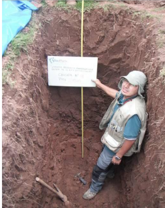
Figura N° 4.29.- Filtración de agua a 1.40m de profundidad, en el contacto entre los estratos limo arenoso y arcilloso. Fuente: Equipo consultor Allin Puriy, 2014
