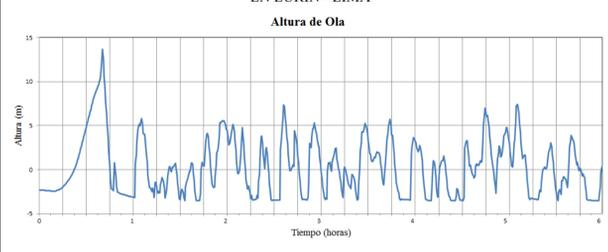
El gráfico representa la variación del nivel del mar debido al tsunami. No se considera el efecto de la marea. La posición del mareógrafo simulado está representada en la carta de inundación por la siguiente simbología:
