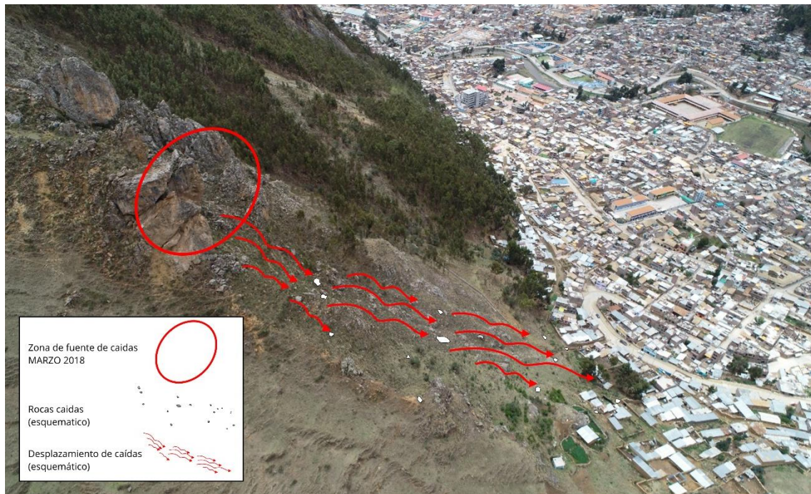
Figura 11. Fotografía aérea de ladera del cerro Aparinacu. Se observa la fuente y trayectoria de las rocas que afectaron viviendas al pie de ladera.
