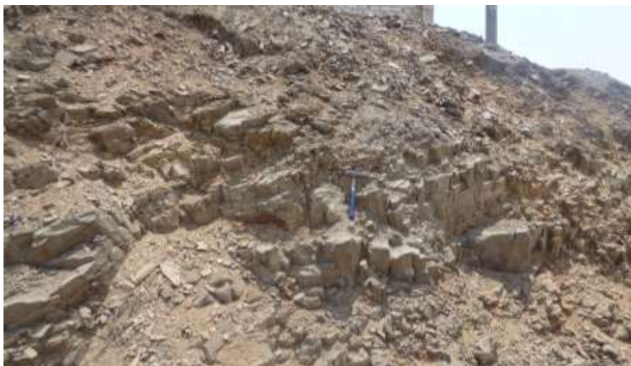
Foto 6: Afloramiento de roca volcánico, con fracturamiento a favor de la pendiente de rumbo: N 200° y buzamiento 55° SW.
