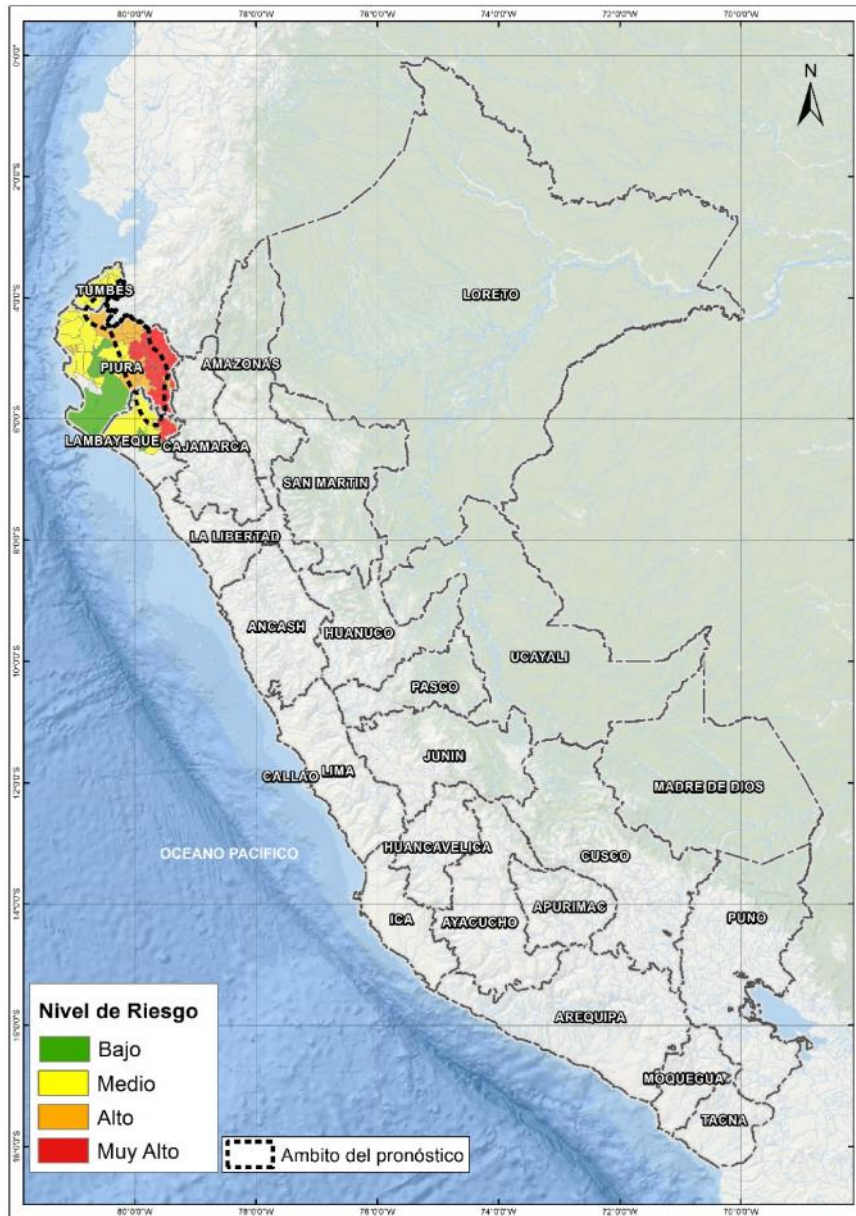
Figura 4. Escenario de riesgo por movimientos en masa en base al pronóstico de lluvias para la Costa Norte del 26 al 28 de febrero de 2019
