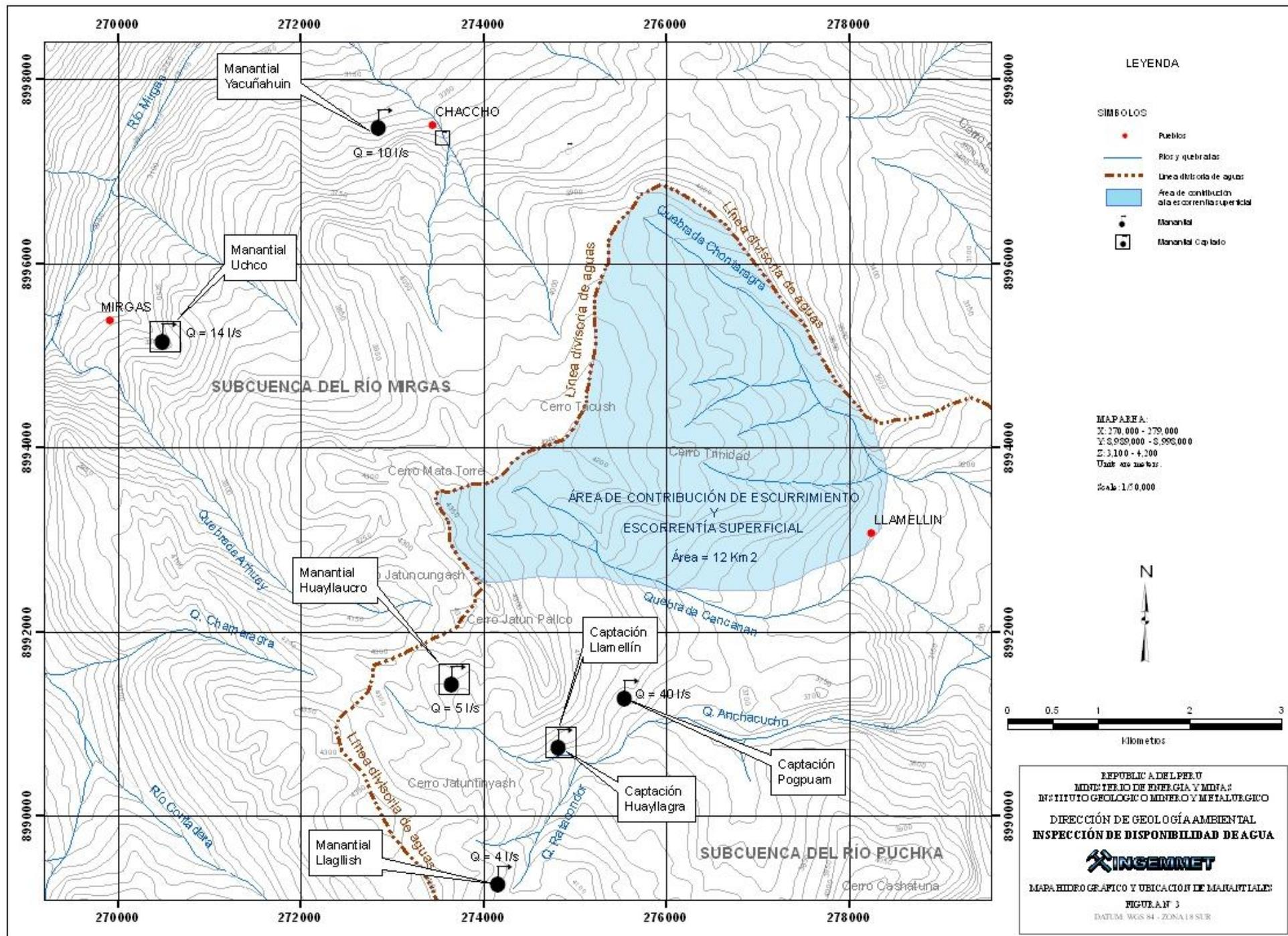
Figura 3. Red de drenaje, área de contribución de agua superficial y ubicación de fuentes de agua subterránea (Manantiales)
