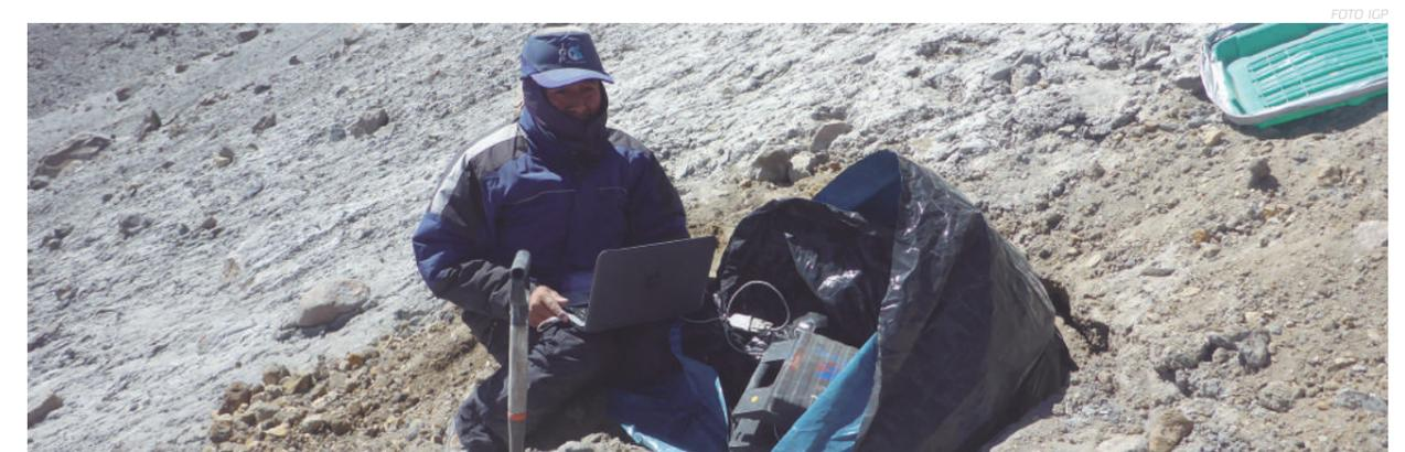
Figura 12.- Profesionales de la sede de Arequipa del Instituto Geofísico del Perú recogen información de la estación del Potencial Espontáneo continuo instalada en el volcán Ubinas.
