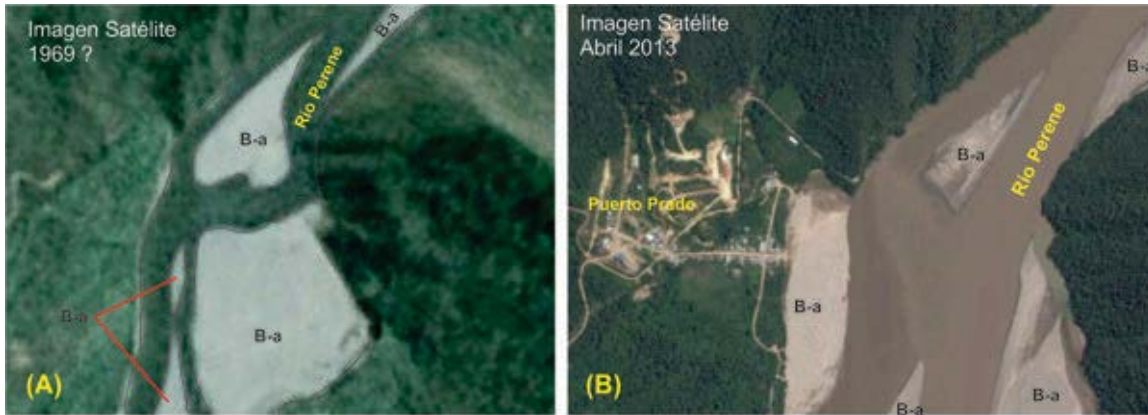
Figura 3A y 3B, Imágenes del Google Earth, se muestra el cauce del río Perene en diferentes años (1969? Y 2013), se aprecian las variaciones del cauce del río en el tiempo.
