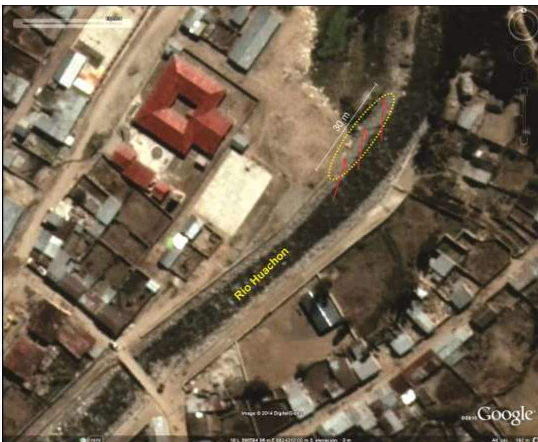
Figura 7. Sector afectado por la erosión fluvial (líneas de color amarillo).
