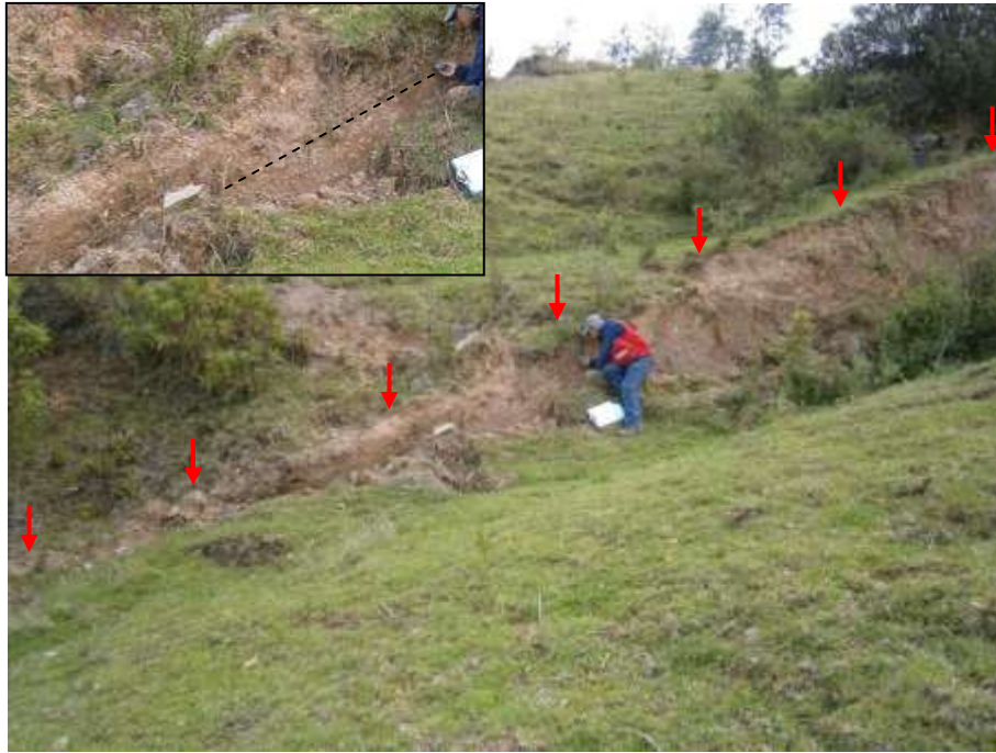
Foto 08: Medida de estrías para determinar el la dirección del movimiento, las flechas rojas demarcan el flanco derecho del deslizamiento C, en la ampliación se muestra en línea punteada la dirección de las estrías.
