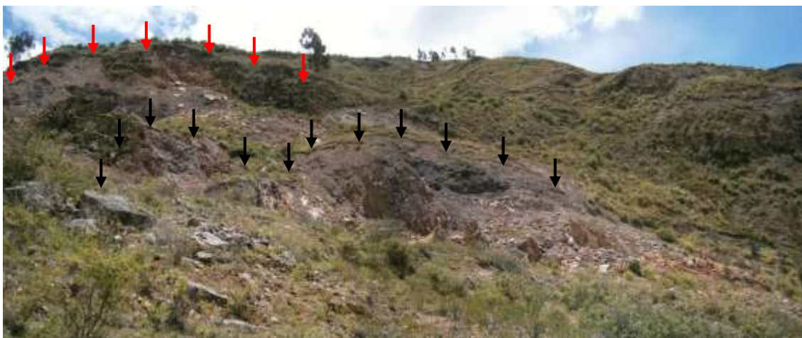
Foto 06: Las flechas rojas demarcan la corona del deslizamiento antiguo y las flechas de color negro delimitan la corona de la reactivación del deslizamiento, constituyendo el derrumbe C-1.
