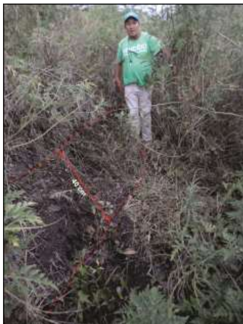
Foto 25. Se muestra una escarpa con desplazamiento de 40 cm., ubicado en la parte posterior de la escarpa principal.
