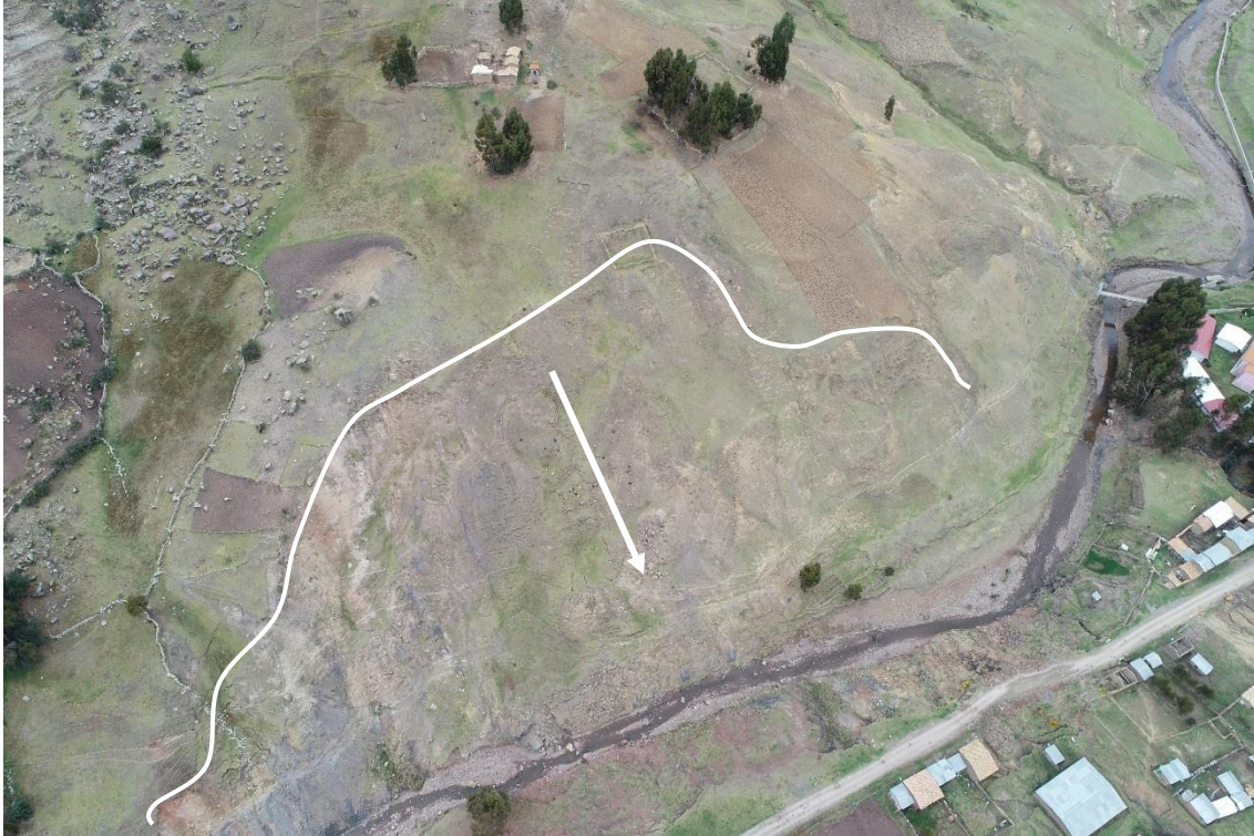
Figura 16. Interpretación de fotografía aérea del deslizamiento ubicado en la margen derecha del río, del sector sureste de Chucllaccasa.
