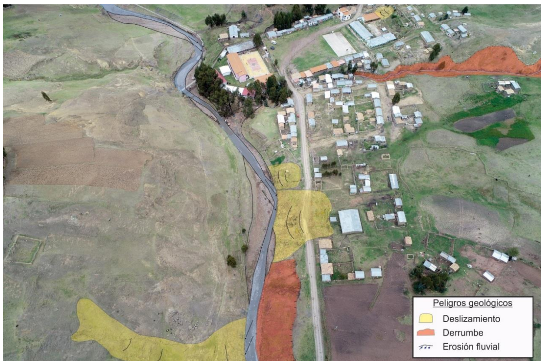
Figura 13. Interpretación de fotografía aérea del sector sureste de Chucllaccasa, se observa en ambas márgenes del río Ancoquisca peligros geológicos de tipo Deslizamiento, derrumbe y erosión fluvial.
