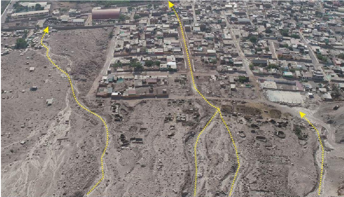
Figura 37. Se muestra las direcciones que tomaron los flujos de detritos, siendo el evento de la parte central la que originó mayor daño a las viviendas.
