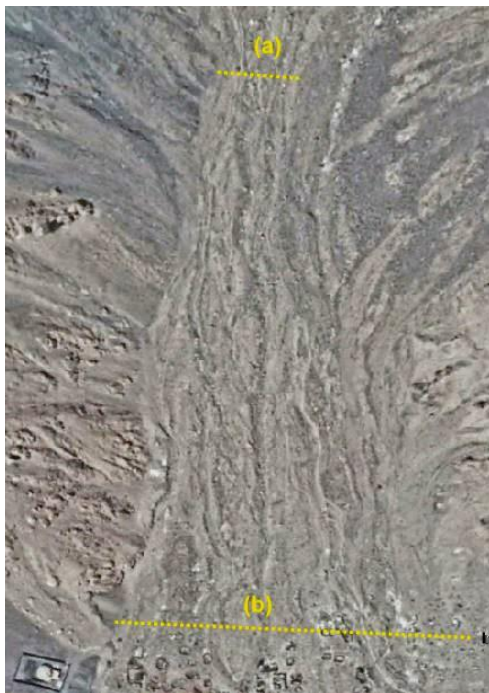
Figura 8. Sector superior de la microcuenca, muestra la pendiente de los terrenos que varían entre 45° a 70°
