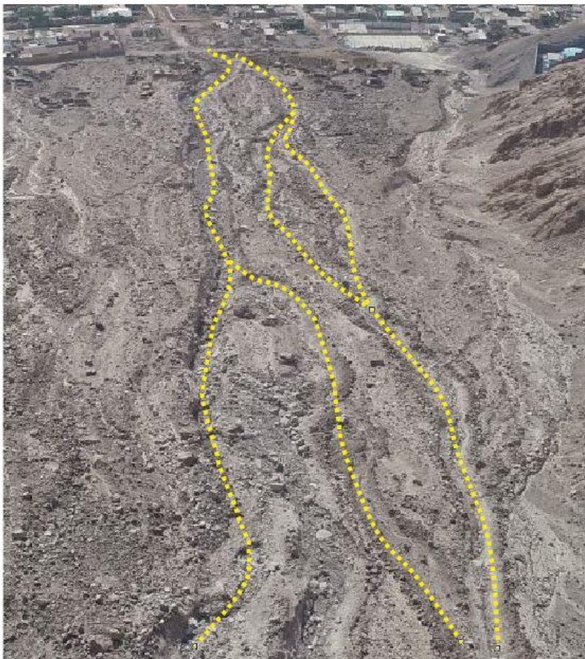
Figura 37. Se muestra las direcciones que tomaron los flujos de detritos, siendo el evento de la parte central la que originó mayor daño a las viviendas.
