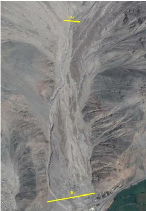
Figura 32. Sector medio inferior de la quebrada Caspani 2, que forma un cono alargado. Inicia (A) con un ancho de 90 m ensanchándose hasta alcanzar los 290 m (B).
