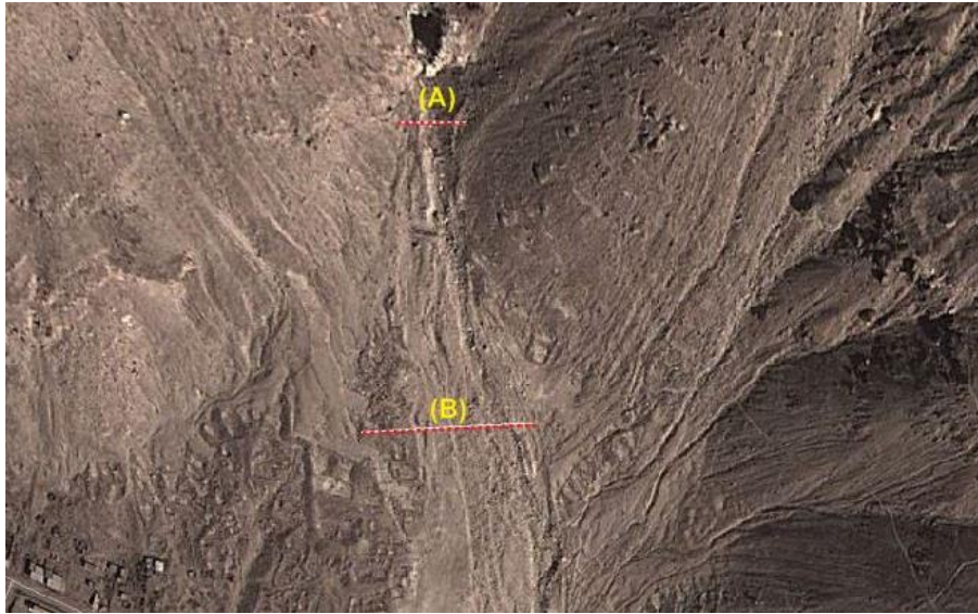
Figura 22. Cauce en el sector medio de la microcuenca. El lado superior tiene una longitud de 35 m que se expande en la parte inferior hasta 95 m.
