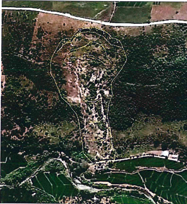
Figura 11. Imagen del Google Earth donde se observa el peligro geológico por movimientos en masa de tipo deslizamiento, ubicado en la coordena UTM WGS84 738690 Este – 9405166 Norte, ocurrido en el año 2002
