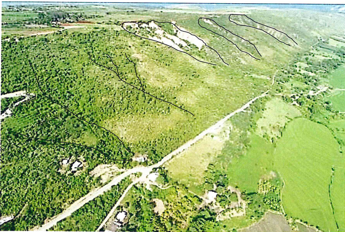
Figura 19. Ladera en la margen izquierda del río Cunia se observa erosión de ladera (surcos y cárcavas), de pendiente fuerte 25^\circ a 45^\circ .
