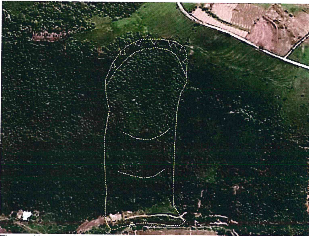
Figura 10. Imagen del Google Earth donde se observa el peligro geológico por movimientos en masa de tipo deslizamiento (coordena UTM WGS84 737856 Este – 94054663 Norte), ocurrido en el año 1999,
