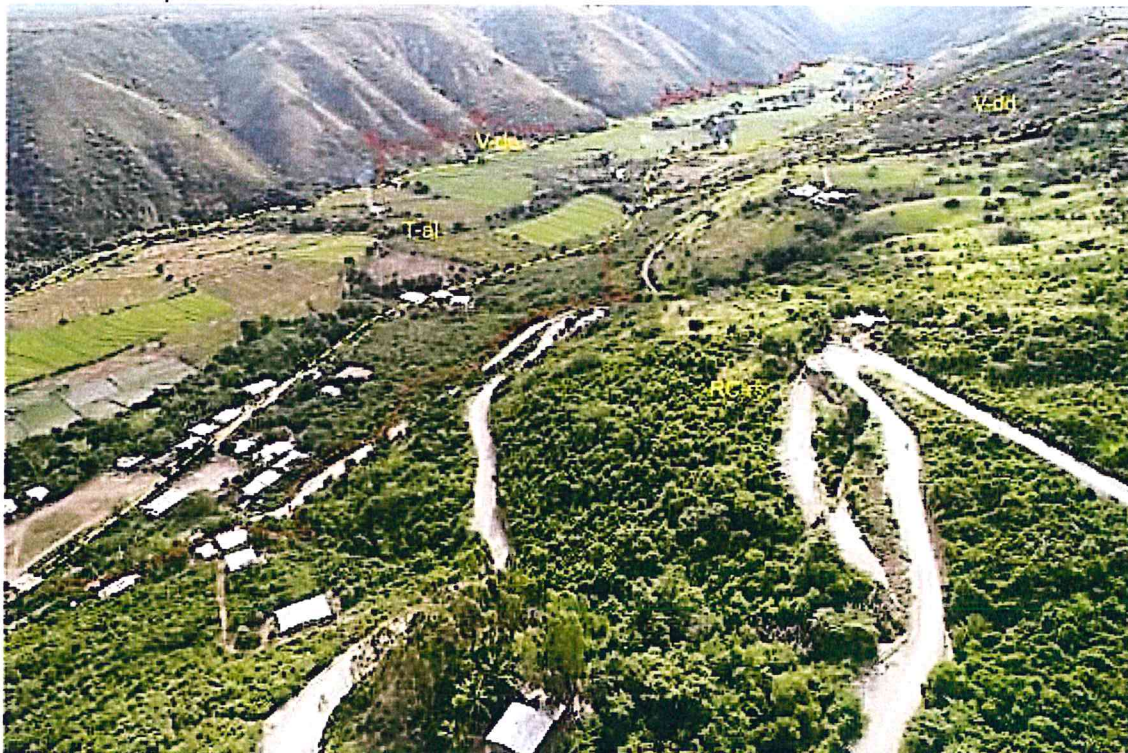
Figura 3. Se observa unidades geomorfológicas en los alrededores del caserío Cunia: Colinas en roca sedimentaria(RC-rs); Vertiente de deslizamiento (V-dd); Vertiente deluvial (V-de) y Terraza aluvial (T-al)
