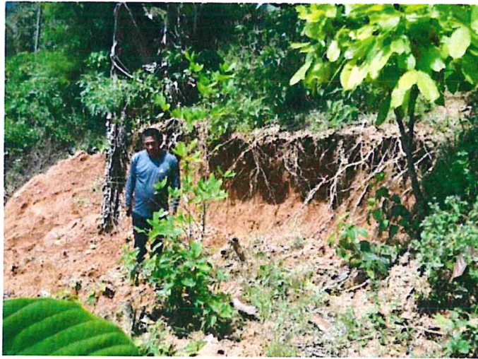
Foto N° 11: Hundimiento de terreno limoarcilloso, similar a la foto anterior, el terreno ha descendido 1.30 m en promedio, con rumbo N75°E, en dirección al río Apurímac.
