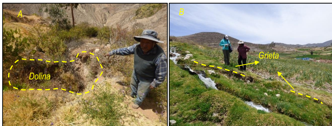
Foto 5. a) Poblador señalando una dolina formada en su terreno agrícola. La dolina mide 2 metros de diámetro. b) Grietas formadas en la superficie de terrenos agrícolas.
