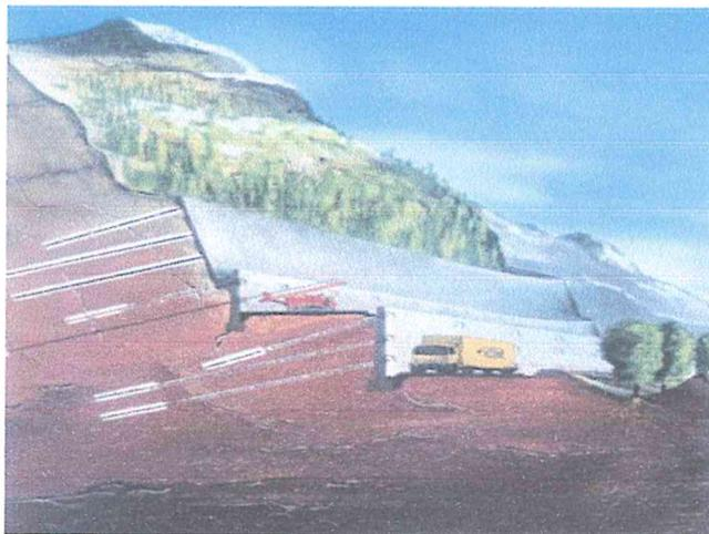
Figura ME1 Estabilización del talud con sistema combinado de banquetas, muros pantalla, pilotes y anclajes.
