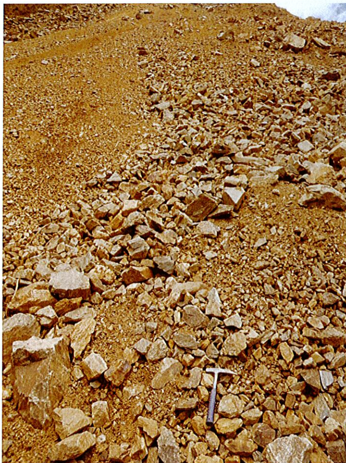
Foto 21: Se observa el material deslizado, compuesto de bloques de rocas, cantos y gravas envueltos en una matriz limosa, que viene bloqueando la quebrada Warmiragra.
