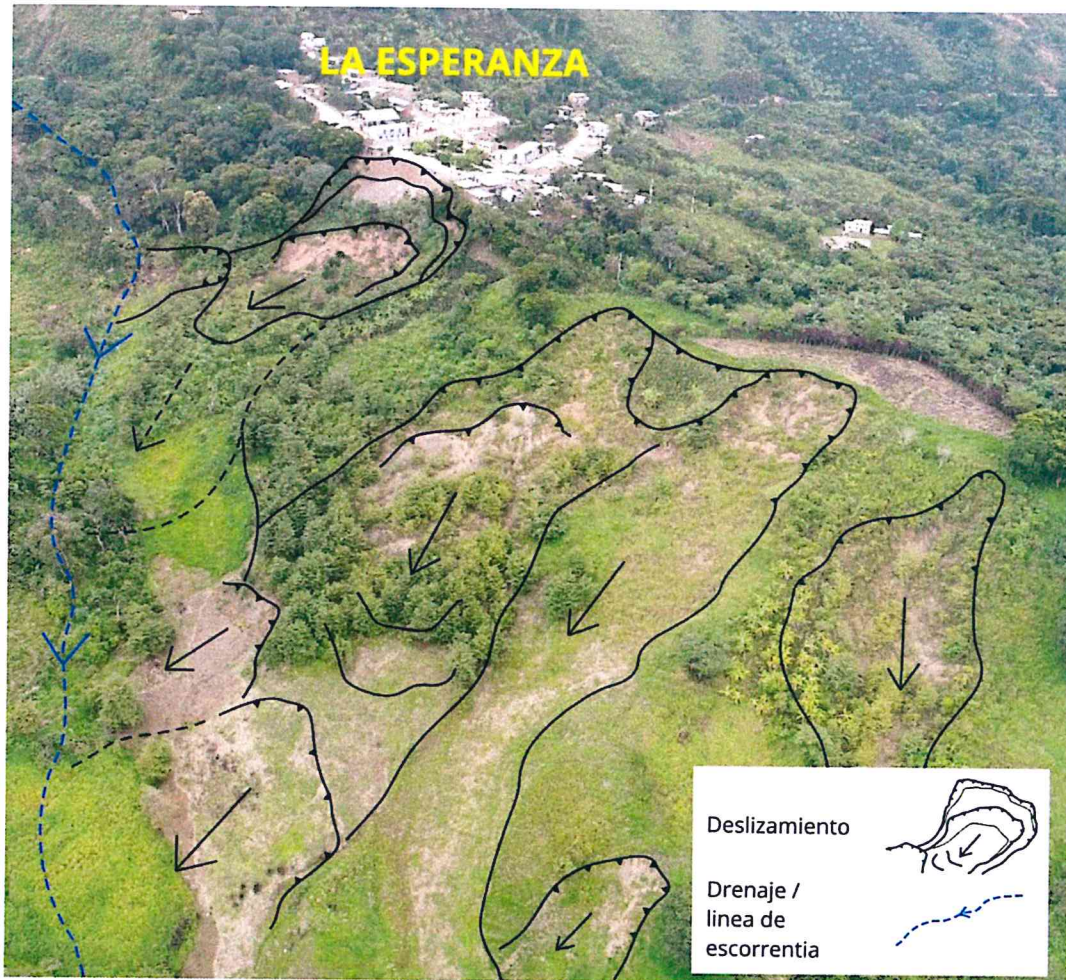
Figura 10. Interpretación de peligros en una fotografía aérea tomada con dron de deslizamientos en el sector oeste y parte baja de La Esperanza.
