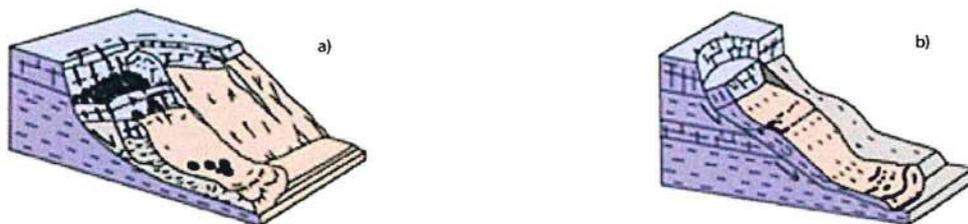
Figura 8. Movimientos complejos: a). Deslizamiento de suelo con detritos de caída de rocas y b). Deslizamiento rotacional-traslacional compuesto, cambiando a flujo de suelo hacia el pie
