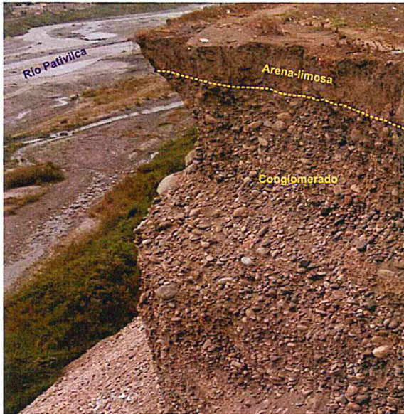
Foto 22. Secuencia arenolimsa, delgada en el tope y de un conglomerado masivo de gran espesor en el nivel inferior.
