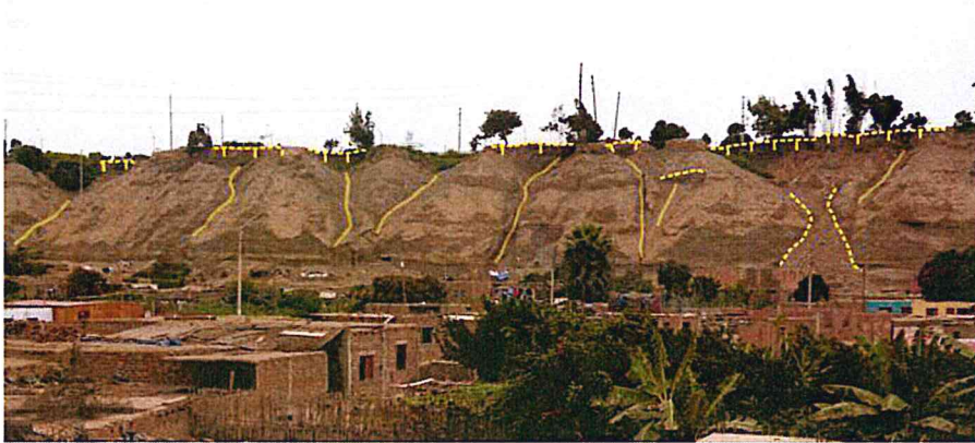
Foto 30. Se muestran los procesos de erosiones (líneas de color amarillo), escarpas en la parte superior o cabecera de cárcava y líneas de dirección de material caído que forman talus de detritos.
