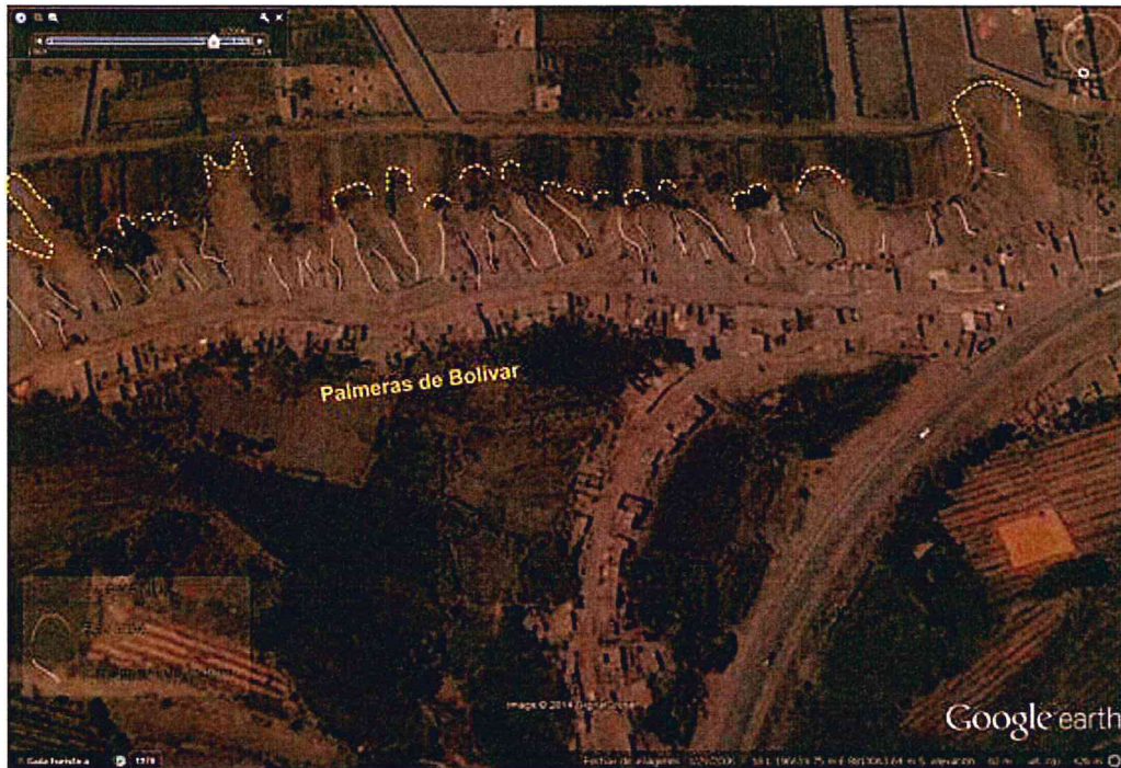
Figura 17. Sector se Palmeras de Bolívar, se aprecian los derrumbes formados por las erosiones de ladera.
