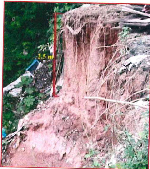
Foto 5: Material de baja resistividad ante la erosión (suelo inconsolidados).
