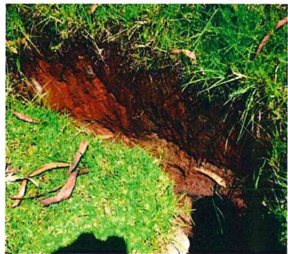
Fotografía 6: (Izquierda) Suelos arcillosos de alta plasticidad en las laderas del sector de Asiacochoa.
