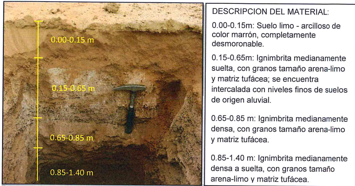
Figura 11. Calicata de 1.40 m de profundidad en Pampa Chapolla, zona propuesta 2.
