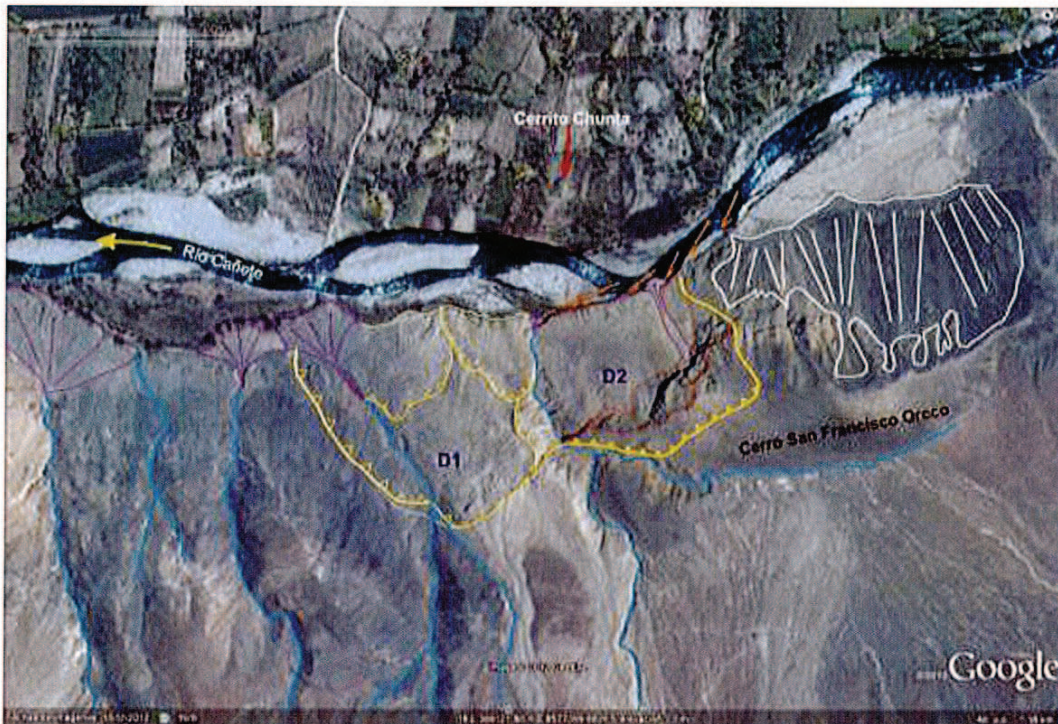
Figura 8: Imagen satelital disponible en el Google Earth, de noviembre del 2012, donde se indica con línea amarilla gruesa, los límites actuales del deslizamiento de Cerro San Francisco Orcco "D2", así como el ensanchamiento sufrido por el deslizamiento "D1".
