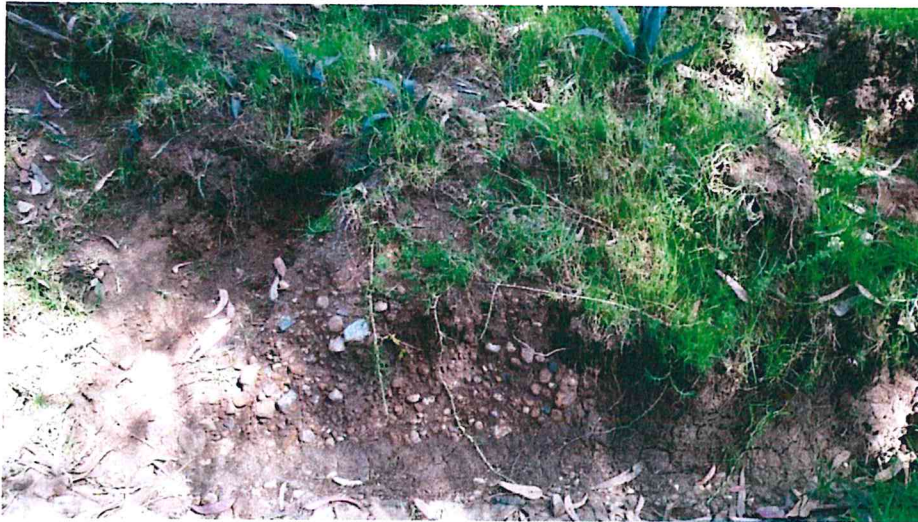
Foto 03. Se observa clastos angulosos a subredondeados envueltos en una matriz.
