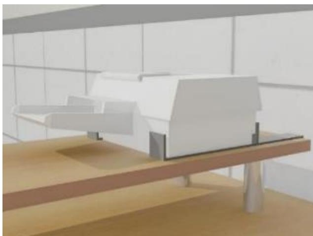
**Figura 59.** Equipos como impresoras deben estar sujetos a asegurados para evitar su desplazamiento ante movimientos sísmicos.
