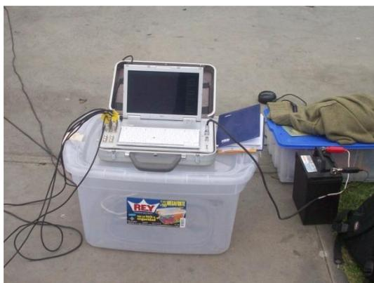
Figura 9 Equipo de adquisición de datos GEODAS 15 HS (izq.) y sensor de 1 HZ de frecuencia tipo CR4.5-1S (der).
