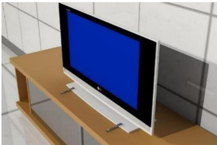
**Figura 63.** Formas de asegurar equipos electrónicos, mediante seguros de correas
