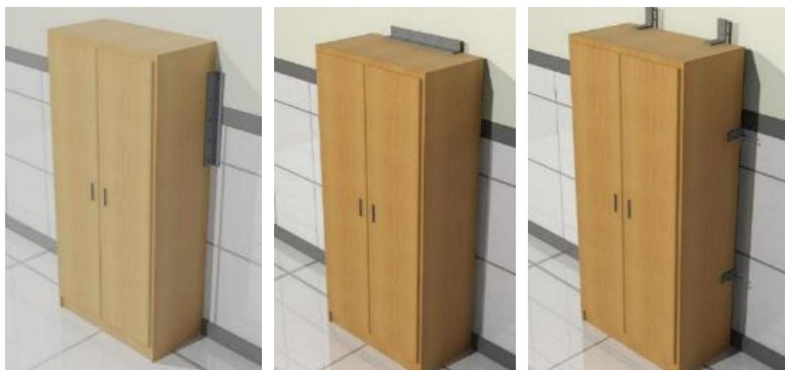
**Figura 61.** Muebles y armarios deben estar fijados y asegurados afín de evitar caídas que afecten al personal de salud o que obstruyan salidas o corredores de evacuación.
