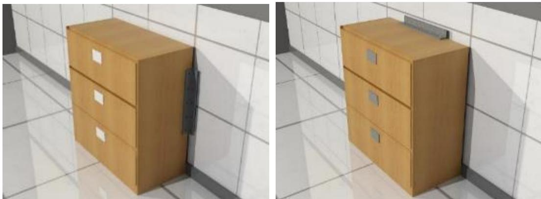
**Figura 60.** Archivadores deben estar asegurados y evitar caídas que obstruyan salidas o corredores de evacuación.
