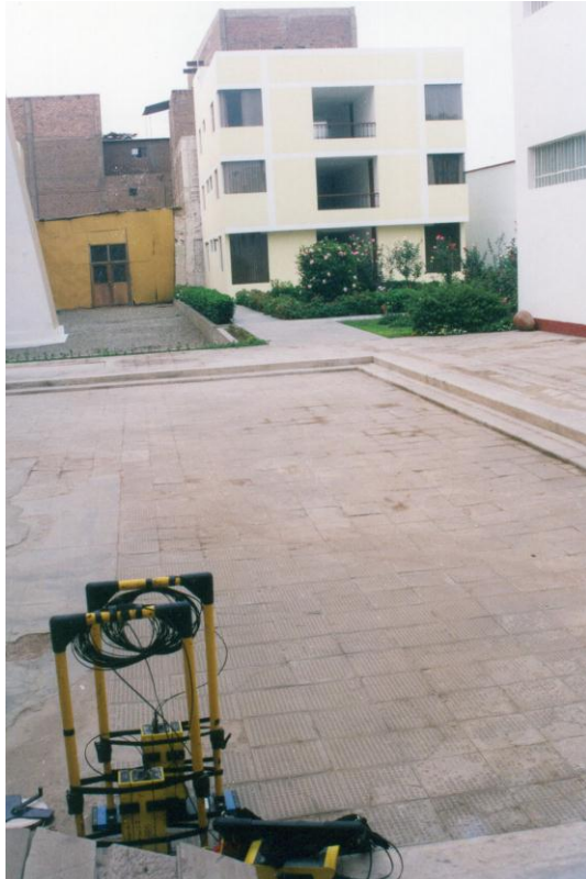
Foto N° 07: Se observa parte del patio principal del arzobispado de Trujillo y las dos antenas de georadar de 200 MHz de frecuencia.
