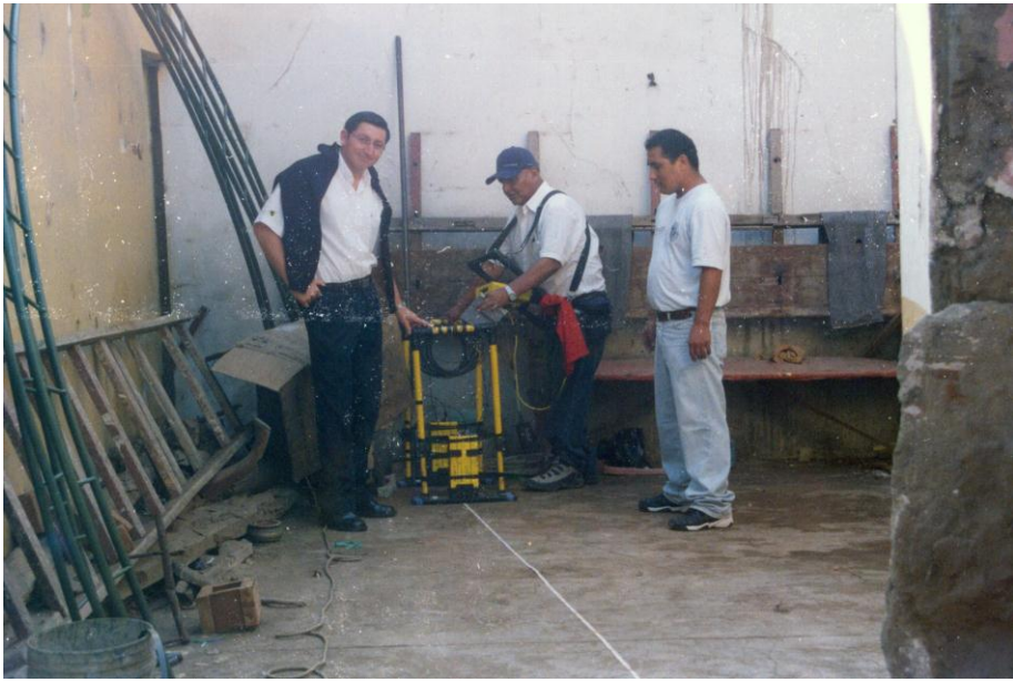
Foto N° 03: Se observa la ubicación de la línea LCP-4 en su tramo inicial punto 0 (38.2 m) se está usando las antenas de 200 MHz.
