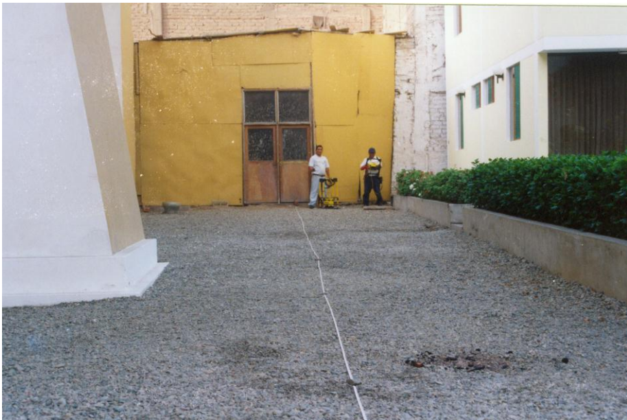
Foto N° 04: Vista hacia noreste se observa el marcado con wincha metrica, de la línea de investigación de Georadar – Línea LAR-1 en el interior del palacio Arzobispal, nótese el punto inicial 0 ( donde se encuentran parados el equipo de registro de GPR Pulse Ekko
