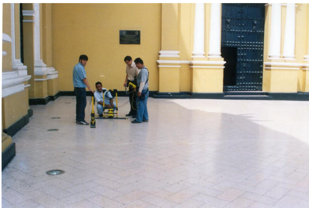
Foto Nº 02: Se observa después de la culminación de los registros de la Línea LA-3 revisando los contactos del cable de fibra óptica y las antenas de 100 MHz.
