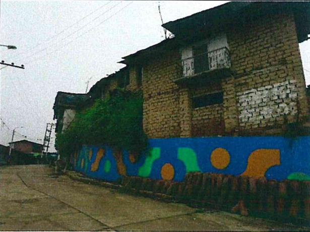
Foto N° 03: Se observa viviendas con material de adobe y techo de calamina, tejas y eternit. Estado de conservación malo.
