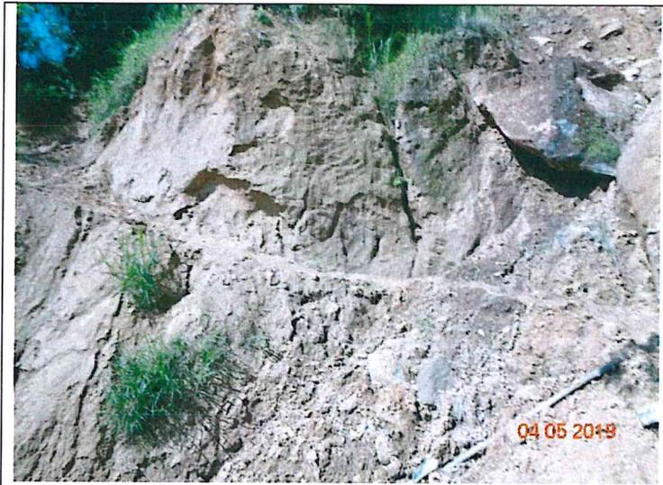
Foto N° 01.- Vista de corte en afloramiento de la tonalita Pambarumbe. Observar el grado de alteración supérgena.
