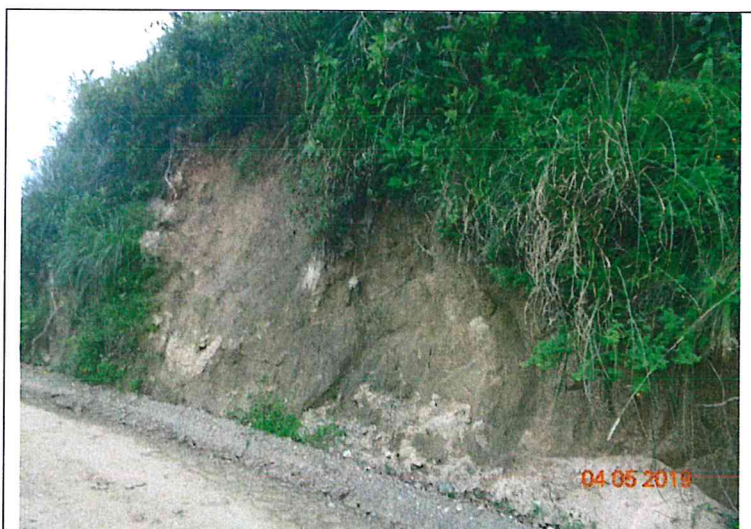
Foto N° 04.- Vista de la unidad intrusiva conocida como tonalita-diorita Pambarumbe. Es una roca que por meteorización es friable y disgregable que se altera a arcillas residuales.
