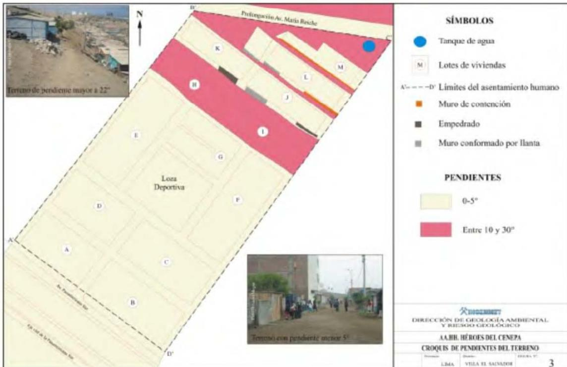
Figura 3.- Croquis esquemático de las pendientes del terreno.
