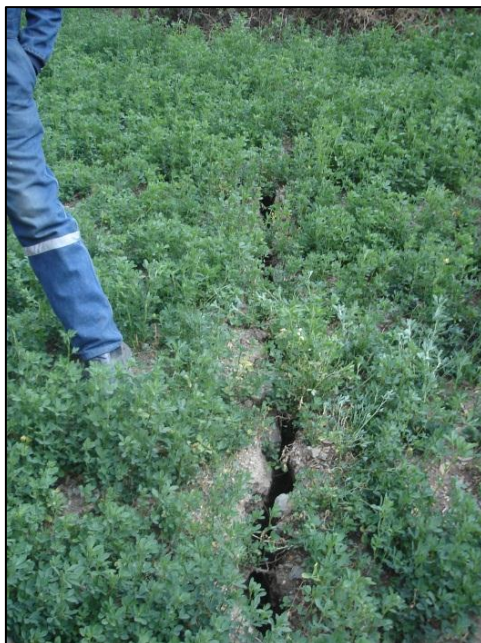
Agrietamientos y asentamientos en los terrenos de cultivo (cultivos de alfalfa)
