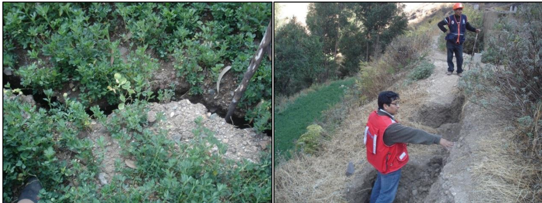
Se muestra los agrietamientos y saltos en el terreno
