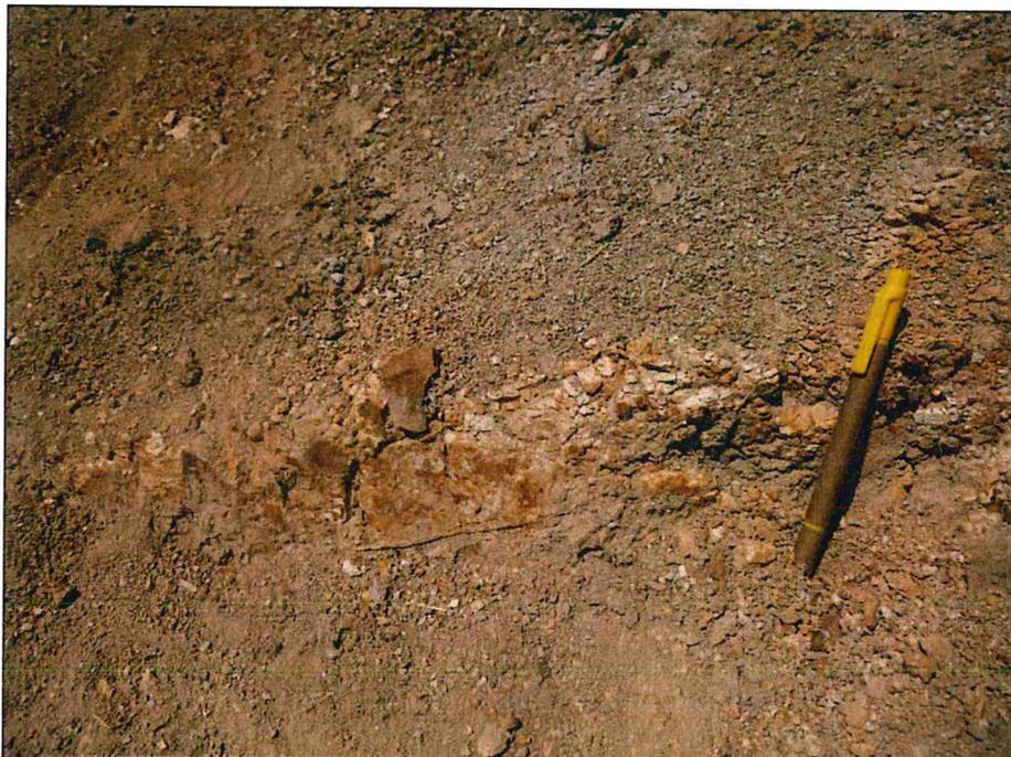
*Fotografía 4: Rocas volcánicas muy deleznables, fácilmente fracturado con la mano.*
