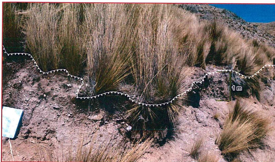
Fotografía 7: Corona del deslizamiento rotacional, muestra la altura del desplazamiento principal
