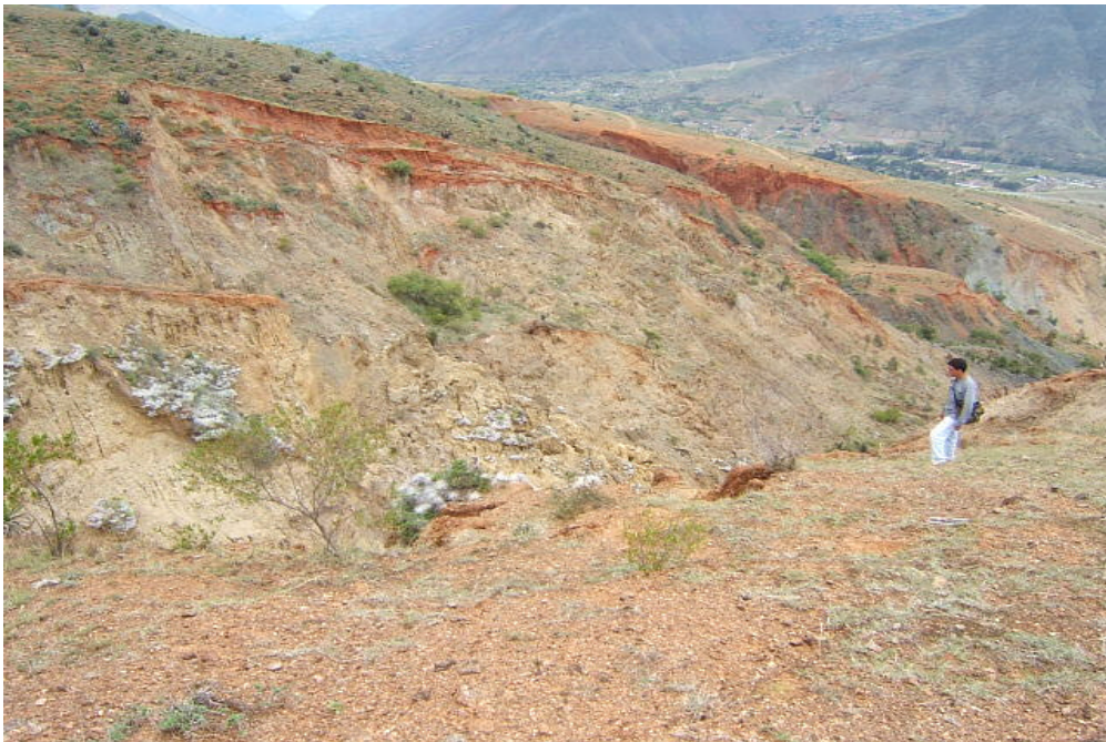
Foto N° 21 Deslizamiento complejo que muestra movimiento rotacional y traslacional, cárcava central en la quebrada La Florida.
