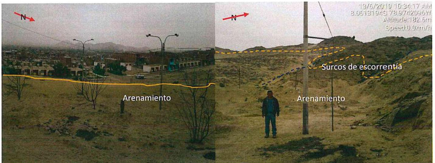
**Figura 29.** Zona susceptible a arenamiento y flujos de lodo. Los cauces de las quebradas se encuentran en dirección hacia el poblado y están cubiertas por arenas. De reactivarse las quebradas podrían llegar a afectar al sector Villa Sol de Laredo. Fuente: Elaboración propia 2019
