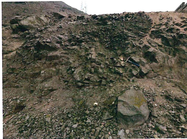
Fotografía 4. Gabrodioritas con presencia de fracturas abiertas con relleno de arcillas, muy cerca al pozo de agua potable que se encuentra en la parte alta de la Cooperativa de Vivienda Virgen de la Nieves.
