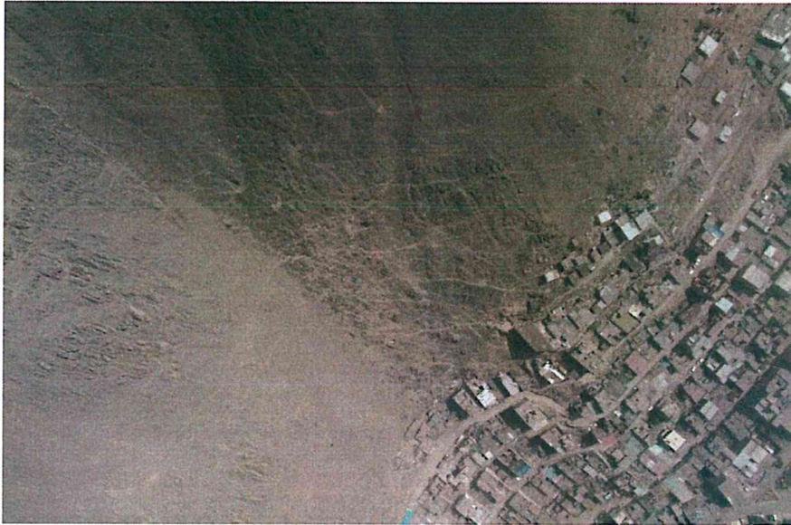
Fotografía 7. Zona 1, Vista de dron, se observa depósitos coluviales, con bloques subangulosos de hasta 1 m de diámetro suspendidos en las laderas del cerro El Agustino, las zonas más afectadas son las viviendas de las manzanas Ñ1 y M2 de la Cooperativa de Vivienda Virgen de Las Nieves.
