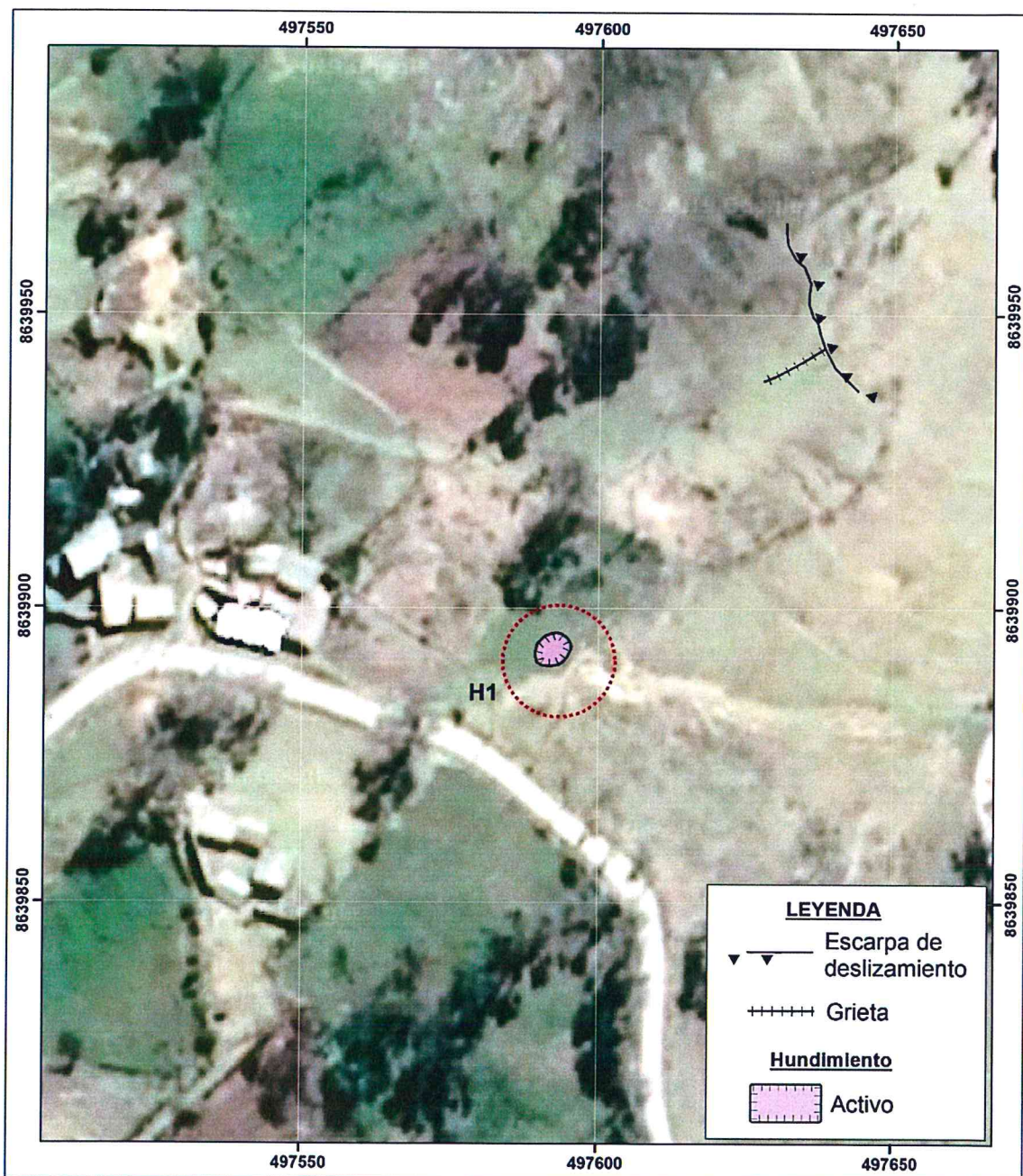
Figura 14: Imagen donde se ha marcado el hundimiento activo y con un círculo de color rojo el perímetro de seguridad a colocar para que la gente no se acerque a la zona hundida.
